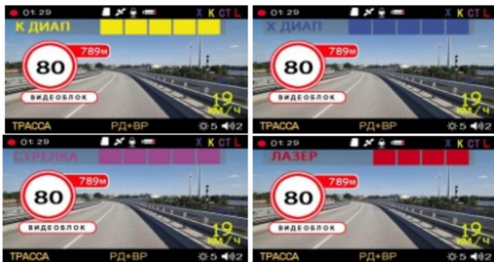
Для удобства использования функции радар-детектора В различных городских условиях и при движении по автотрассе в устройстве имеются соответствующие режимы работы Город/трасса :
